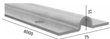
Рельс Ω-образной формы, самоочищающийся, травмобезопасный
