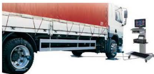
Измерения на задней тележке автопоезда
