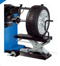
Подъёмник колеса **BW 2010** является универсальным устройством для подъёма колёс до 70 кг; может использоваться с балансировочными стендами Hofmann для легковых автомобилей geodyna® 7100, 7200, 4500-2, 7300, 7500, 7340, 7600.
