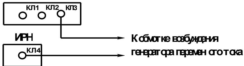
Рисунок 15 Схема подключения обмотки возбуждения генератора.
